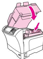
8. Wenn weiterhin eine Meldung zu einem Medienstau angezeigt wird, befinden sich immer noch gestaute Druckmedien im MFP-Gerät. Suchen Sie an einer anderen Stelle nach dem Stau.
