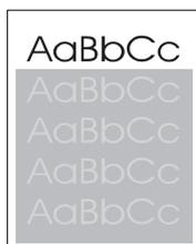
Wenn ein Druckbild, das oben auf einer Seite (in Schwarz) gedruckt wird, weiter unten auf derselben Seite (in einem grauen Bereich) wiederholt wird, wurde der Toner nach dem letzten Druckauftrag möglicherweise nicht vollständig von der Walze entfernt. Die Wiederholung kann heller oder dunkler als der Bereich sein, in dem sie angezeigt wird.
