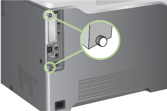
4. Lösen Sie die Flügelschrauben, und ziehen Sie die Formatierungskarte aus dem Produkt heraus. Legen Sie die Formatierungskarte auf eine saubere, ebene, geerdete Fläche.
