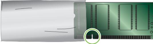
8. Halten Sie das DIMM an den Seitenkanten fest, richten Sie die Einkerbung am DIMM an der Führung im DIMM-Steckplatz aus, und drücken Sie das DIMM fest in den Steckplatz, bis es vollständig eingerastet ist. Wenn Sie das DIMM korrekt installiert haben, sind die Kontakte nicht zu sehen.
