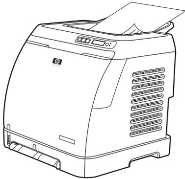
3. Nachdem der Auftrag abgeschlossen ist, entfernen Sie das restliche unbedruckte Papier, wenn Sie auf dem Bedienfeld dazu aufgefordert werden. Nehmen Sie den bedruckten Stapel aus dem Ausgabefach, und legen Sie ihn in das Druckerfach ein, das für den ersten Teil des Auftrags verwendet wurde. Achten Sie dabei darauf, dass Sie den Stapel weder drehen noch wenden.
