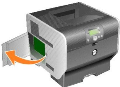
**ANMERKUNG:** Optionskarten können leicht durch statische Entladungen beschädigt werden. Berühren Sie einen Metallgegenstand (z. B. den Druckerrahmen), bevor Sie eine Optionskarte anfassen.
