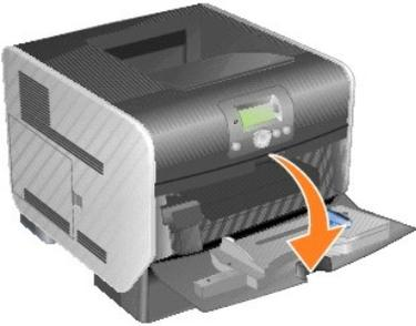
3. Drücken Sie die Entriegelung nach rechts, und öffnen Sie die obere vordere Abdeckung.
