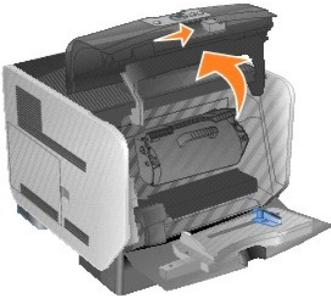
4. Heben Sie die Druckkassette an, und ziehen Sie sie aus dem Drucker heraus.
