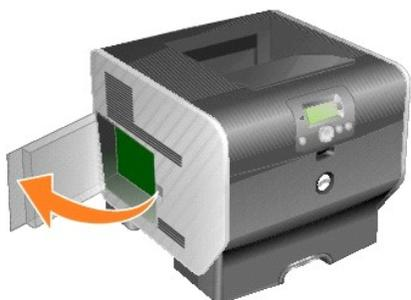
**⚡ ANMERKUNG:** Druckerspeicherkarten können leicht durch statische Entladungen beschädigt werden. Berühren Sie einen Metallgegenstand (z. B. den Druckerrahmen), bevor Sie eine Speicherkarte anfassen.
