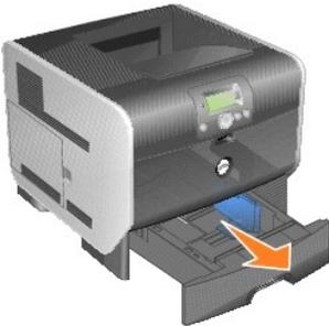
2. Drücken Sie die Verriegelungen der Seitenführung zusammen, und schieben Sie die Führung an die Außenkante des Fachs.
