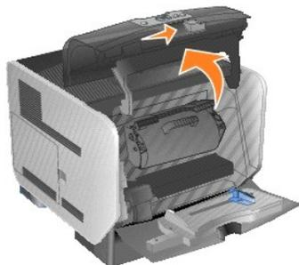
3. Heben Sie die Druckkassette an, und ziehen Sie sie aus dem Drucker heraus.
