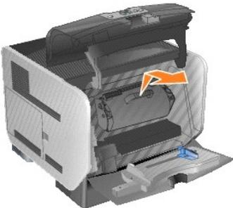
**⚠ ACHTUNG:** Wenn Sie eine Druckkassette austauschen, setzen Sie die neue Druckkassette nicht für einen längeren Zeitraum dem Licht aus. Wenn sie zu lange dem Licht ausgesetzt wird, kann dies zu Druckqualitätsproblemen führen.
