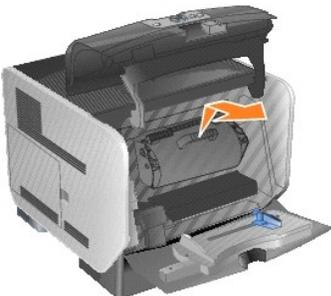
5. Die gebrauchte Übertragungsrolle befindet sich unten im Druckergehäuse.
