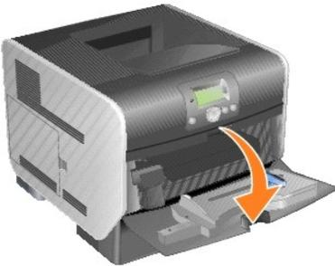
2. Drücken Sie die Entriegelung nach rechts, und öffnen Sie die obere vordere Abdeckung.
