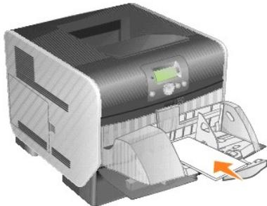
6. Schieben Sie die Seitenführung nach links, bis sie den Stapel leicht berührt. Achten Sie darauf, dass die Briefumschläge sich nicht aufbiegen.
