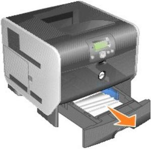
2. Öffnen Sie das Duplexfach des Druckers, und ziehen Sie die gestauten Medien zum Entfernen nach oben.
