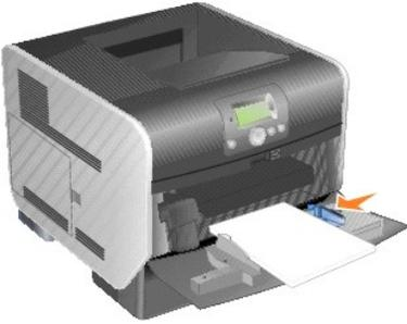
7. Stellen Sie die Optionen **Papierformat** und **Papiersorte** für die Universalzuführung (unter **Univ.Zuf. Format/Typ**) auf den korrekten Wert für die eingelegten Druckmedien ein.
