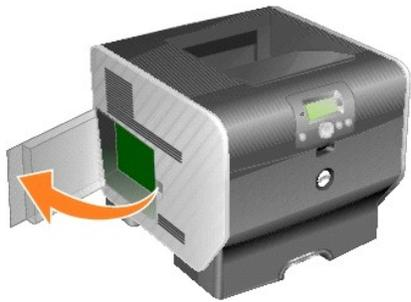
**HINWEIS:** Wenn eine Optionskarte installiert wurde, müssen Sie diese unter Umständen vor dem Installieren der Schriftarten-ROM entfernen.
