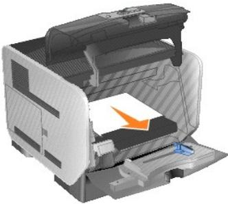
6. Richten Sie die Druckkassette aus, und setzen Sie sie erneut ein.
