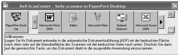
Die auf PaperPort und Dell ScanCenter beschränkten Programme werden durch Symbole auf der Dell ScanCenter-Leiste dargestellt. Um ein Element zu scannen und an ein Programm zu senden, klicken Sie auf das Programmsymbol und scannen Sie anschließend das Element. Wenn der Scanvorgang abgeschlossen ist, wird das ausgewählte Programm automatisch von Dell ScanCenter gestartet.
