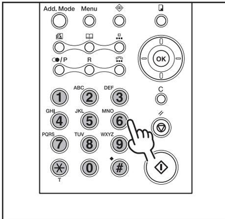
Verwenden Sie die numerischen Tasten, um die Faxnummer des Empfängers einzugeben.
