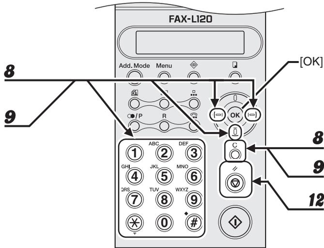
**8** Drücken Sie [abwärts] und verwenden Sie [Links/Rechts], [Löschen] sowie die numerische Tasten, um erforderlichenfalls die Subadresse zu ändern.
