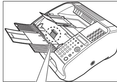
Entfernen Sie das gesamte Dokument aus dem ADF, falls ein mehrseitiges Dokument geladen ist.
