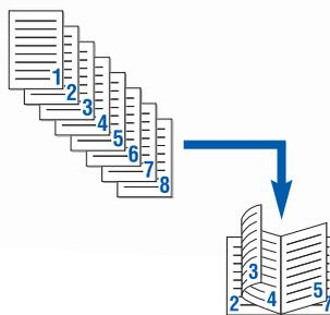
Mit der Duplexeinheit und der integrierten Broschürendruck-Funktion der HL-6050D und HL-6050DN wird aus einem mehrseitigen DIN A4 Dokument automatisch eine Broschüre im DIN A5 Format. So erstellen Sie problemlos Folder, Preislisten, Telefonlisten, Informationsbroschüren und Prospekte in Kleinserie.
